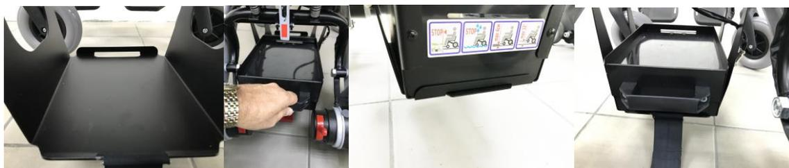
2. Взять верхний корпус блока АКБ за ручку и придерживая второй рукой установить его сверху на нижний корпус блока АКБ, слегка подать его вперед и затем вниз до упора, чтобы выступ в верхнем корпусе блока АКБ вошел в паз нижнего корпуса, при этом электрические контакты нижнего корпуса блока АКБ и верхнего сомкнутся.
